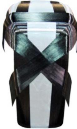
Fibre placement systemen voor droog carbon of glas zonder binder, thermoplastische tapes en towpregs. Door de ultra-snelle aanklevening van het garen aan de uiteinden van de mal is dit een uitstekend placement systeem voor de snelle produktie van voorvormen met een minimaal verlies aan materiaal. Ideaal voor o.a. overmoulding met thermoplasten.
